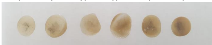
Образцы ПЭЭК после закалки и отжига при 160 °C 0 мин 15 мин 30 мин 60 мин 120 мин 240 мин
